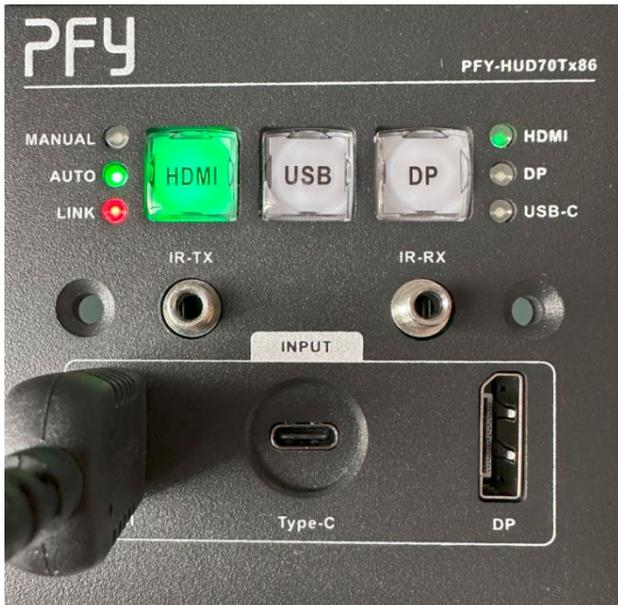
Mit der IR (Infrarot) Funktion können Endgeräte, die sich außerhalb der Reichweite der Fernbedienung des Empfängers befinden, gesteuert werden.
