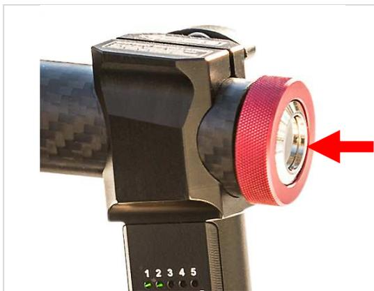
1. **Gimbal einschalten.** Drücken Sie den Power-Schalter an der 2-Hand-Halterung bis er einrastet. Das Gerät wird initialisiert und Sie hören eine Tonfolge.
