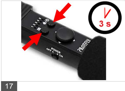
1. **Drücken Sie die MODE-Taste und die HOME-Taste gleichzeitig 3 Sekunden lang** und schalten Sie dann die Fernbedienung aus. Schieber auf "OFF".
