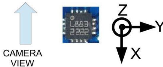
在轴顶端参数，明确那个轴正在朝向上方。在轴右边参数，指明哪个轴朝向右方，以拍摄的方向观察（如图所示，Axis TOP = Z, RIGHT = Y）。在控制器里输入设置，等待它重启。
